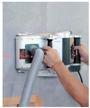
Предназначен для получения штробы (канавки) в бетоне, кирпичной кладке, камне и т.п. Высокая мощность и скорость вращения определяют повышенную производительность, а отсутствие необходимости выборки материала снижает временные и трудовые затраты на получение штробы.
