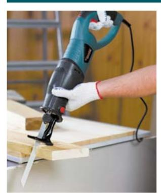
С помощью соответствующей оснастки инструмент способен проводить резы в древесине, пластике, металле, в том числе заподлицо с поверхностью.
