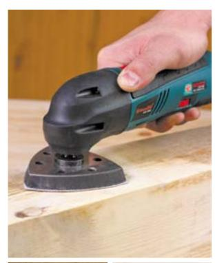
Аккумуляторный многофункциональный инструмент с возвратно-поступательным движением для пиления, резки, шлифования и зачистки различных материалов.
