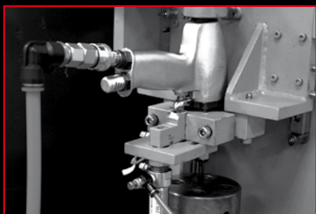
Испытательный стенд для пневматических отвёрток пистолетного типа.
